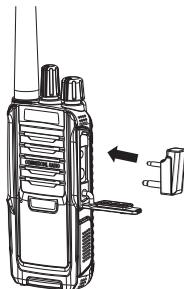
**Примечание:** При подключенном внешнем динамике или микрофоне радиостанция не является водонепроницаемой.
